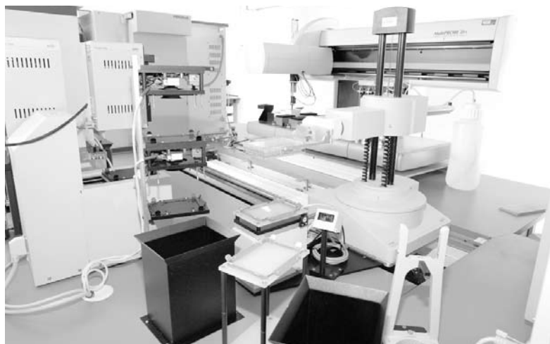
Robot caco-2, le plus productif au monde, propriété unique d'Oroxcell et conçu par la société. Il sert à cultiver des cellules intestinales humaines pour étudier l'absorption des médicaments et des produits dans l'intestin. © Oroxcell.
